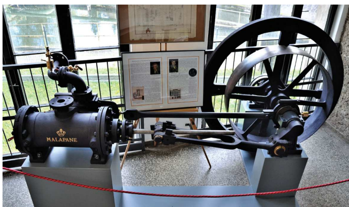
Maszyna parowa wyprodukowana w Hucie Małapanew w roku 1860 w pełnej okazałości na wystawie w Muzeum Hutnictwa
